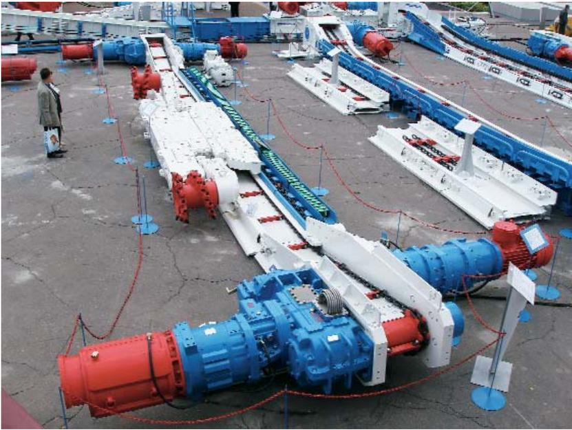
На снимке: забойный конвейер СП251.13
