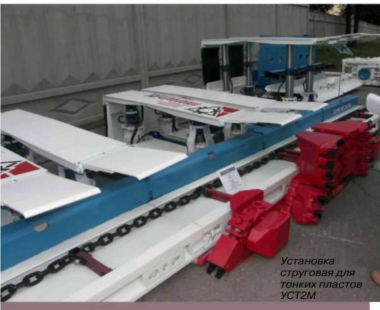
Установка струговая для тонких пластов УСТ2М
