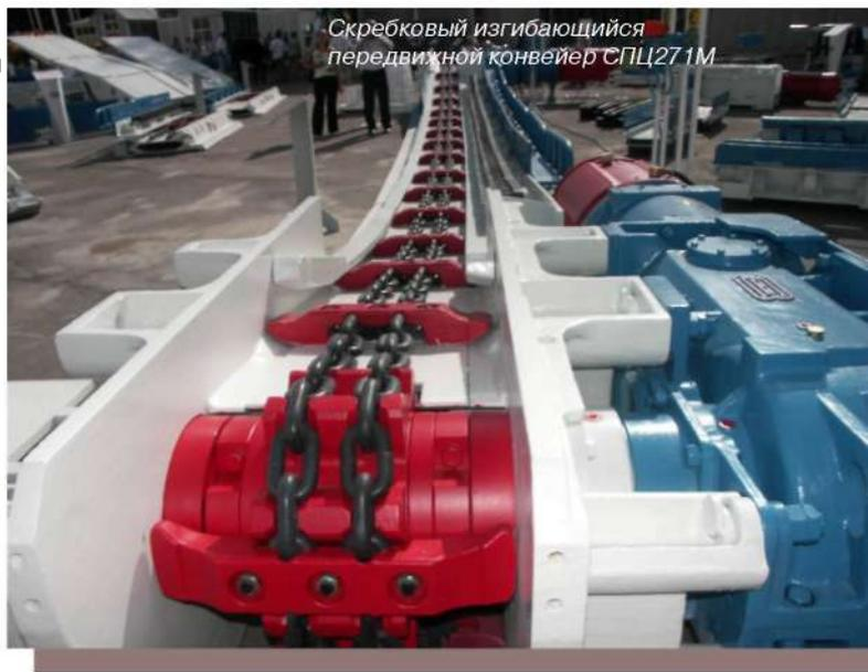
Скребокный изгибающийся передвижной конвейер СПЦ271М
